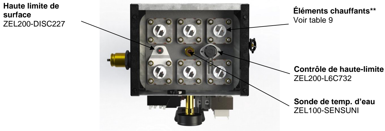
Figure 22 : Pièces de rechange, BTH Ultra 208/240/480/600V-3 ph.
