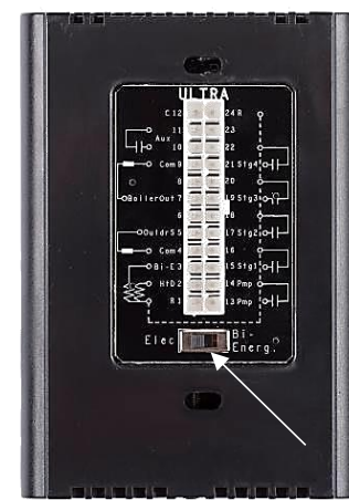
Figure 9: Arrière du contrôleur
