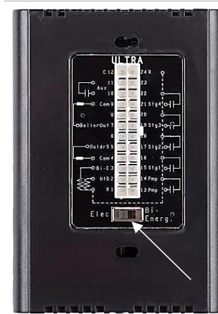
Figure 9: Arrière du contrôleur
