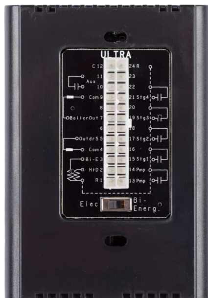
Figure 11: Arrière du contrôleur
