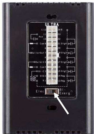
Figure 19 : Arrière du contrôleur
