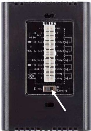
Figure 19 : Arrière du contrôleur
