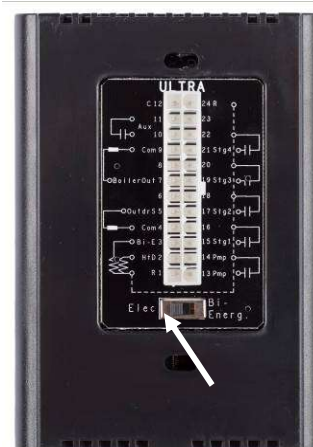
Figure 16 : Arrière du contrôleur
