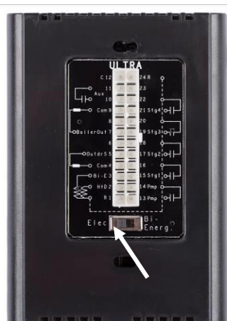
Figure 14 : Arrière du contrôleur
