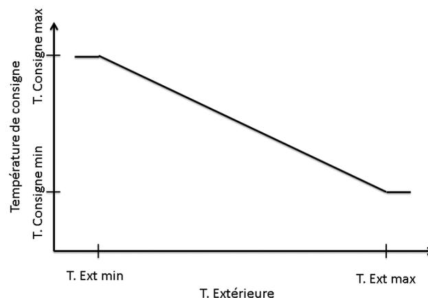
**Figure 17 : Courbe d'ajustement Modulation T. Extérieure**
