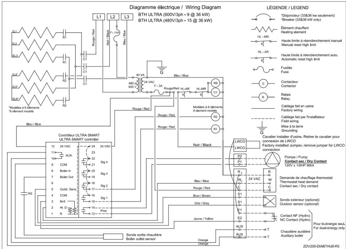
**Figure 16 : Diagramme électrique 480/600V-3ph**
