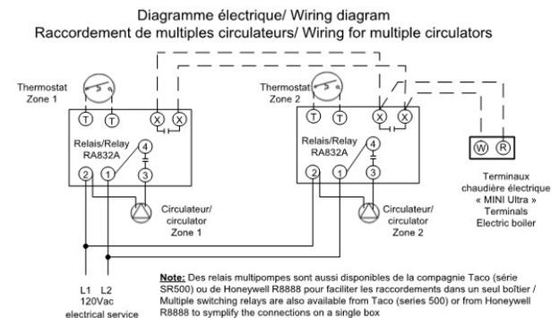
Figure 11 : Schéma de zonage par pompes multiples
