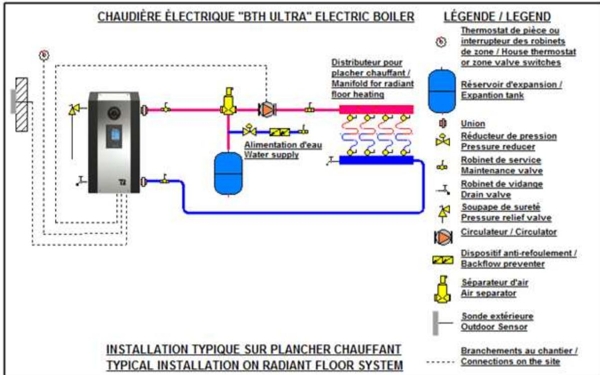
Figure 4 : Installation sur système de plancher chauffant
