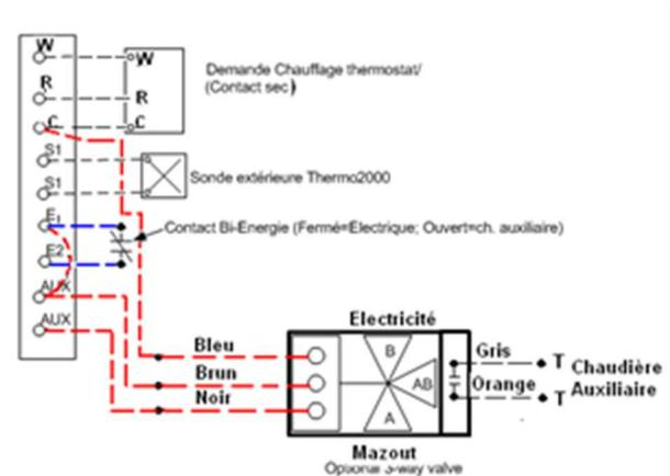
Figure 14 : Raccord avec valve trois voies
