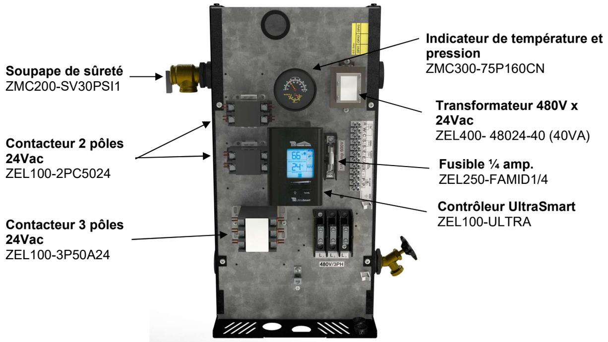
Figure 21 : Pièces de rechange BTH Ultra 480V-3 ph.
