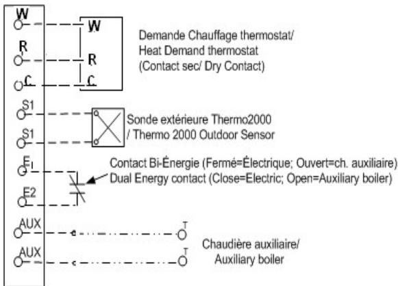
**Figure 9 : Raccord sans valve 3 voies**
