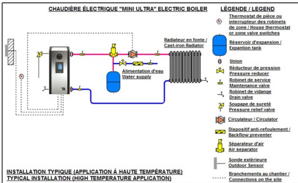
Figure 5 : Schéma d'installation pour application à haute température
