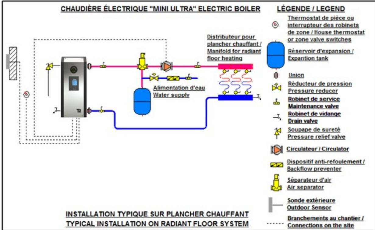
Figure 4 : schéma d'installation sur plancher chauffant
