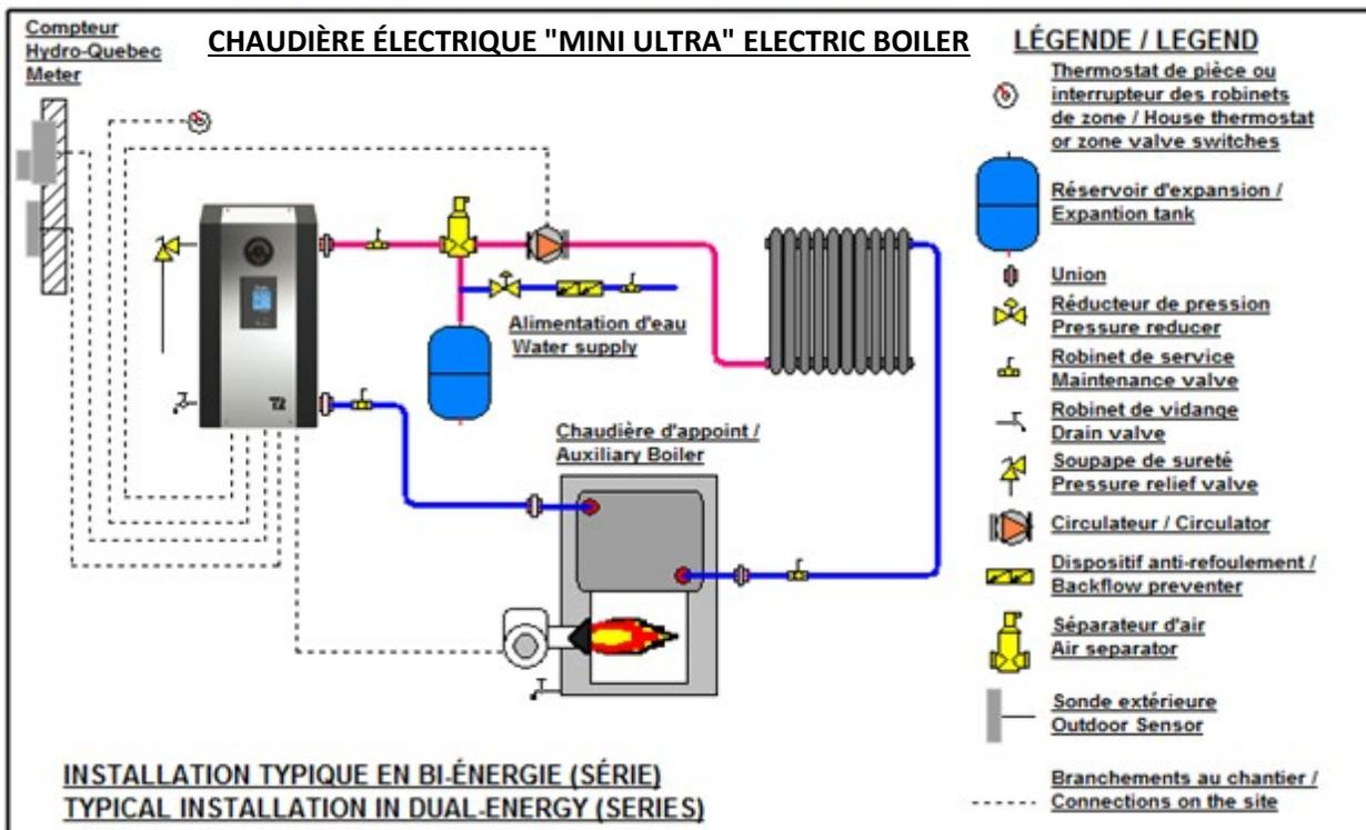
Figure 6 : Installation Bi-énergie en série (modèles USA seulement)
