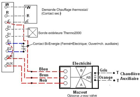
**Figure 10 : Raccord avec valve trois voies**
