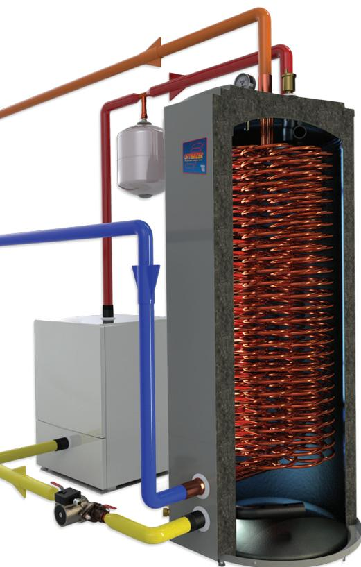
**OPTIMIZER 43** est un chauffe-eau indirect instantané, spécialement conçu pour l'usage résidentiel. Cet appareil contient un échangeur à trois serpentins de cuivre qui assure une eau chaude domestique renouvelée à tout moment, pour une qualité d'eau potable supérieure. Les injecteurs brevetés utilisent le liquide caloporteur du système pour chauffer indirectement en 7 secondes l'eau potable qui circule dans l'échangeur pour tous les besoins d'une famille, à chaque utilisation.
