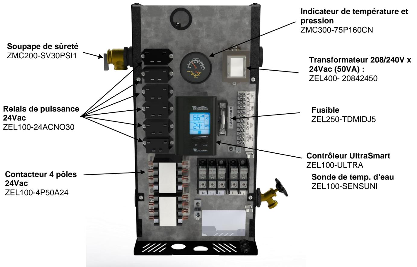
Figure 22 : Pièces de rechange, vue de face (27-29 KW)
