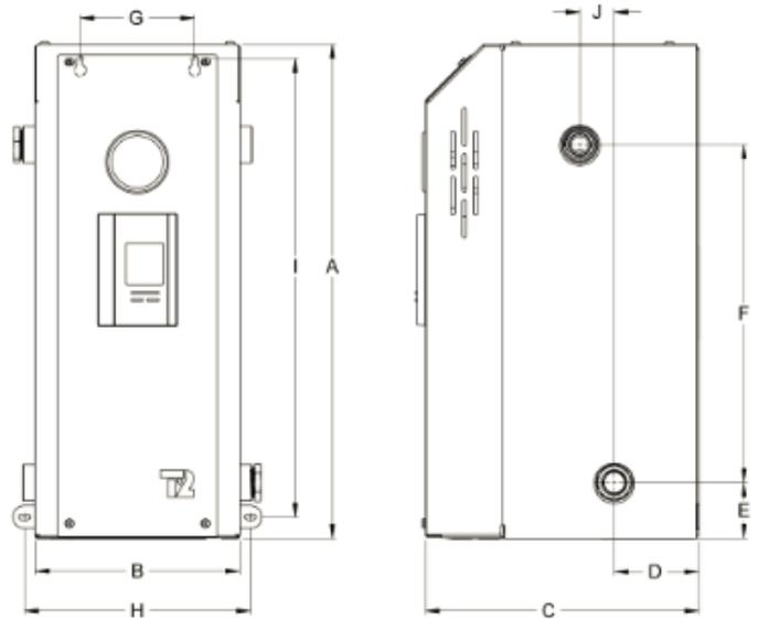
**Figure 1 : Dimensions de la chaudière (12-24 KW)**
