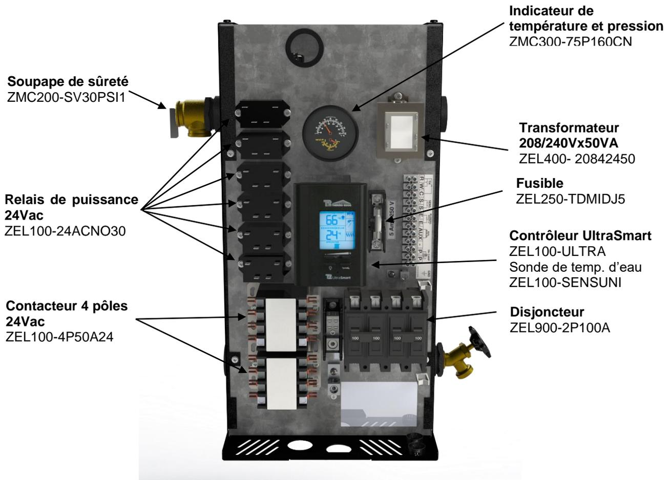
Figure 24 : Pièces de rechange, vue de face (33-36 KW)
