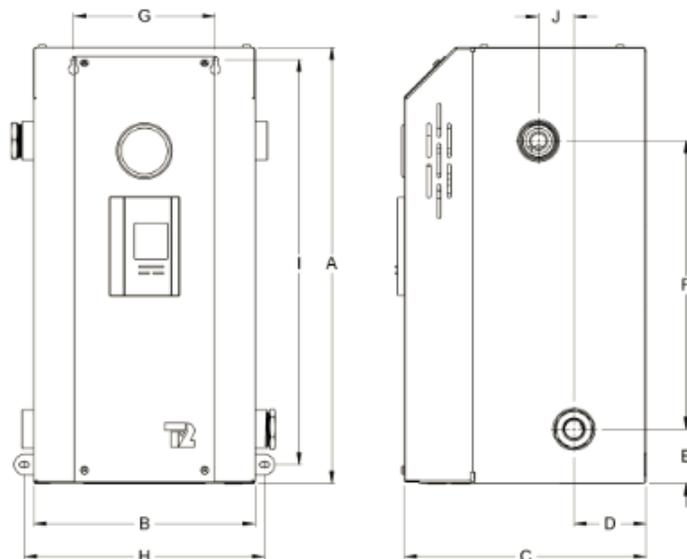
**Figure 2 : Dimensions de la chaudière (27-36 KW)**
