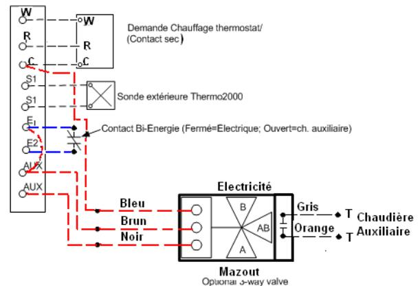
Figure 14 : Raccord avec valve trois voies
